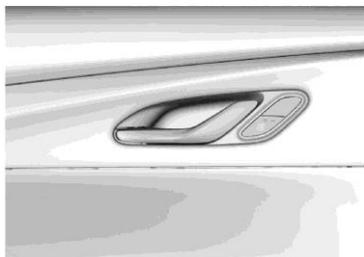
Функция обогрева※ сидений заднего ряда может быть включена нажатием переключателя
