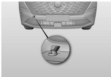
Передний буксировочный крюк должен быть ввинчен в подрамник под правой стороной переднего бампера, убедитесь, что резьба крюка полностью ввинчена в буксировочную трубу. При первом использовании из-за влияния электрофорезной краски может потребоваться большее усилие для закручивания.
